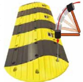
**Nota:** Para una mejor sujecion untamos pegamento epóxico de manera uniforme en las anclas.
