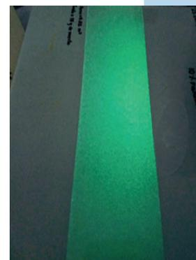
Figura 1- Pintura termoplástica día (izq) y noche (der).
